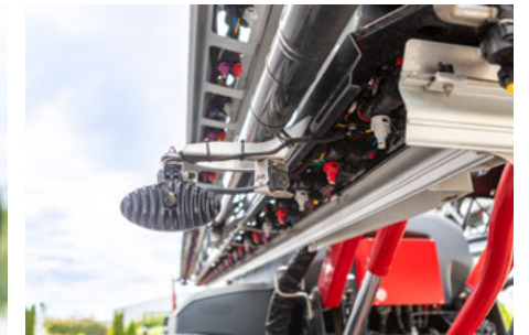
Kamera zur Düsenüberwachung am NightLight Halter
