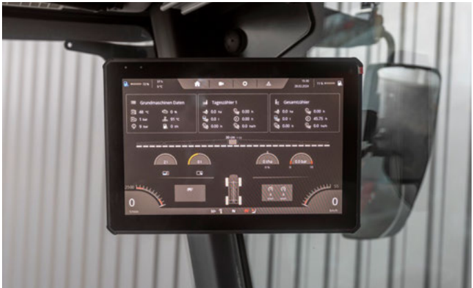
Serienmäßiges 12" A-Säulen-Display mit frei belegbarer Anzeige
