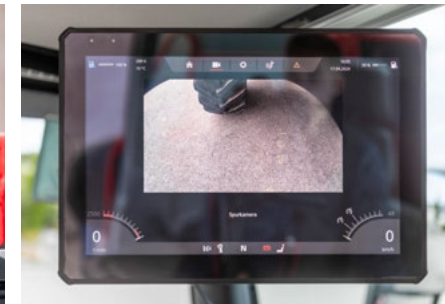
Hochauflösende, individuelle Darstellung der Spurkamera im A-Säulen-Display
