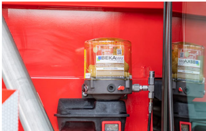
Behälter der Zentralschmieranlage
