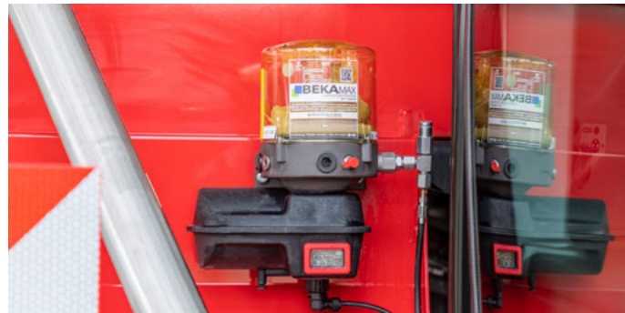
Behälter der Zentralschmieranlage
