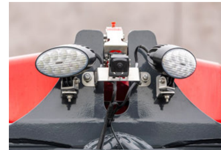
Rückfahrkamera für die Kontrolle des Bereiches hinter dem Fahrzeug
