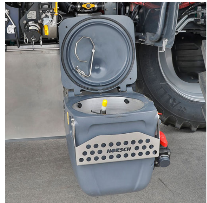
52 l Edelstahl Einspülschleuse inkl. zusätzlicher Stoßdüse
