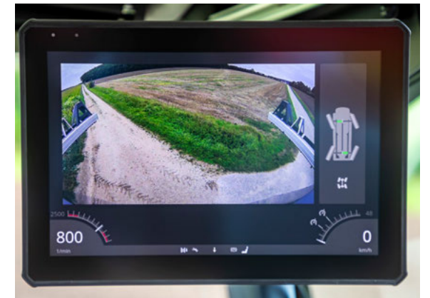
Hochauflösende, automatische Darstellung der Rückfahrkamera im A-Säulendisplay
