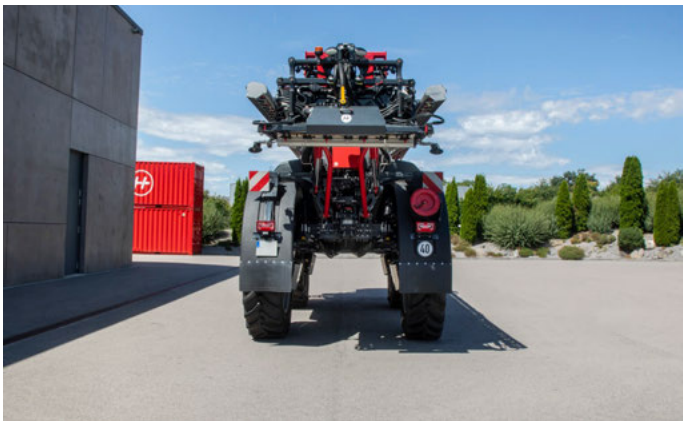
Hintereinander liegende Schiebeachsen und hydropneumatische Federung
