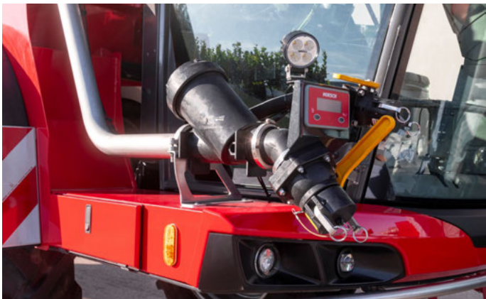
Fremdbefüllanschluss 3" inkl. Filter neben der Kabine
