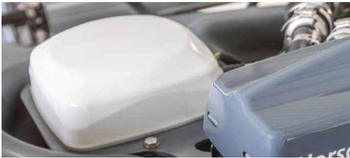
Empfänger Trimble Nav 900
