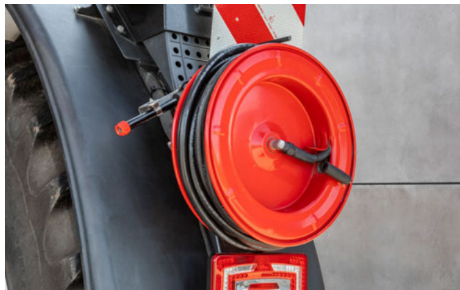
Schlauchtrommel zur Außenreinigung
