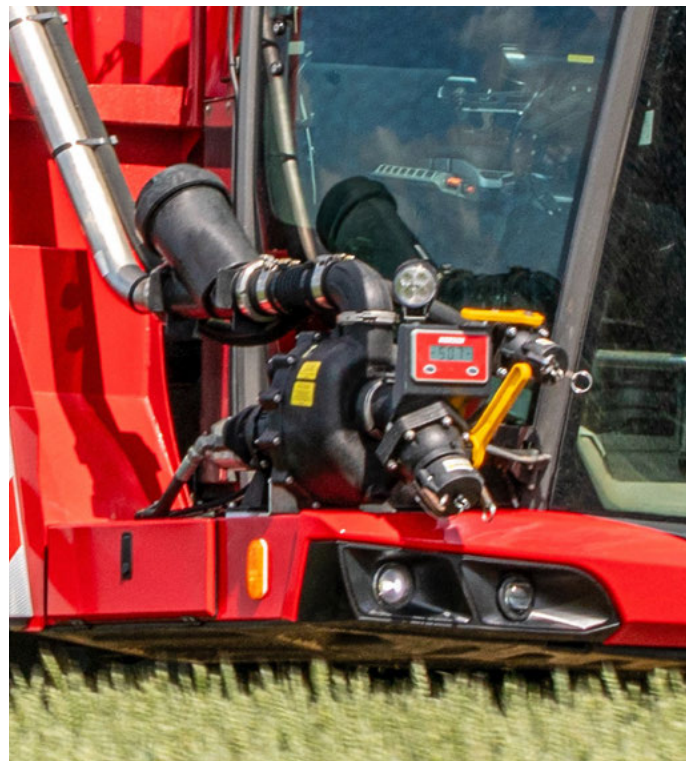
PowerFill Befüllpumpe mit 1 000 l/min Leistung - 3" Camlock Befüllanschluss vorne und Display
