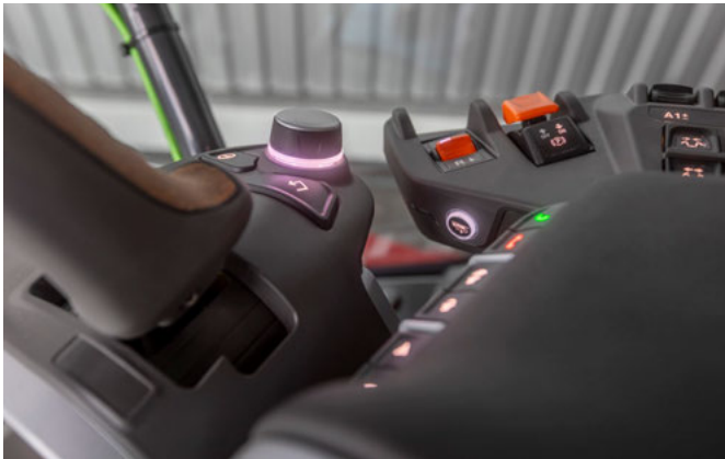
Sichere Bedienung des A-Säulen-Displays: Dreh-/Drückfunktionen
