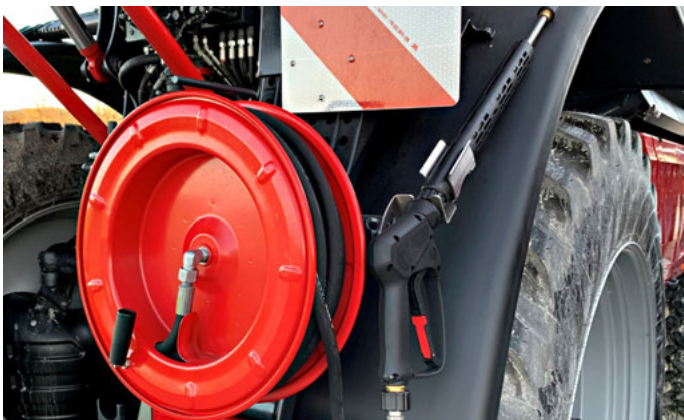
Hydraulisch betriebener Hochdruckreiniger
