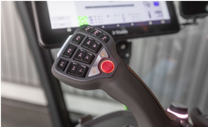
Ergonomischer Fahrhebel mit mehrfach belegbaren Tasten
