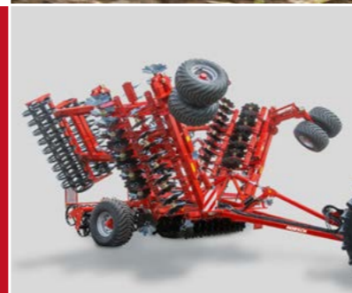
Joker 10/12 RT Компактная конструкция; транспортная ширина 3 м, транспортная высота 4 м
