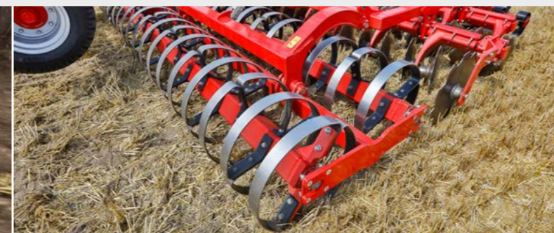
Двойной каток RingFlex – большая площадь опоры и малое тяговое сопротивление
