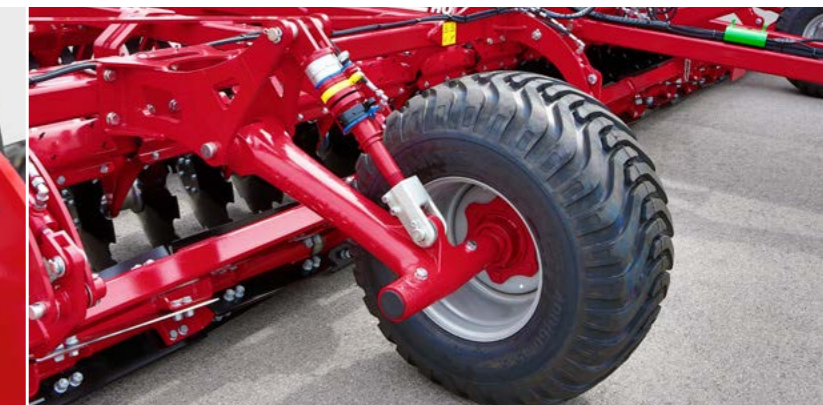
Регулирование глубины обработки с использованием дистанционных клипс (стандарт)
