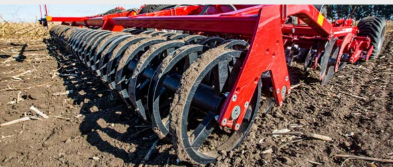
Двойной каток RollPack оптимален для крошения и обратного уплотнения на большинстве типов почв
