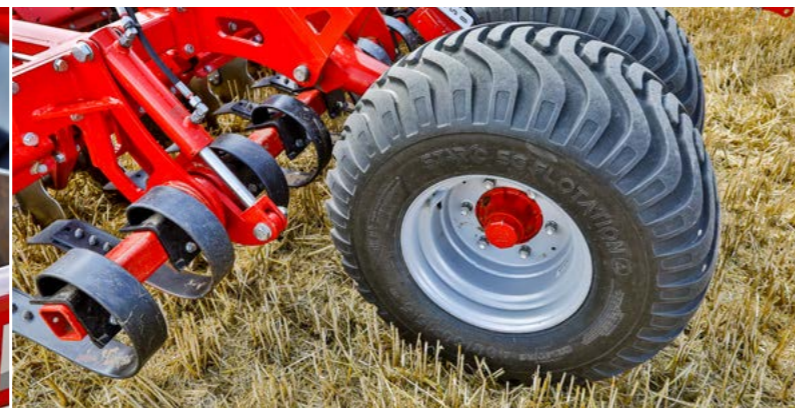
Глубина обработки регулируется изменением положения опорных колес
