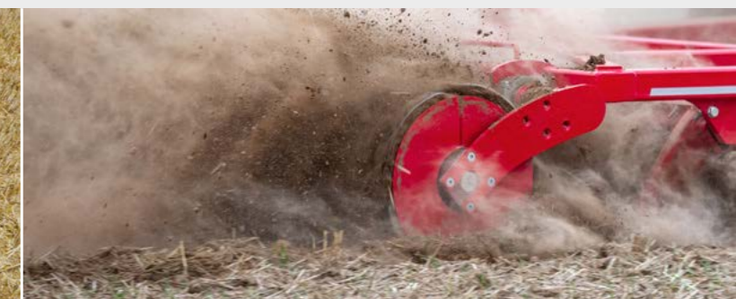
Каток RollFlex – высокое качество крошения вследствие вибрации элементов
