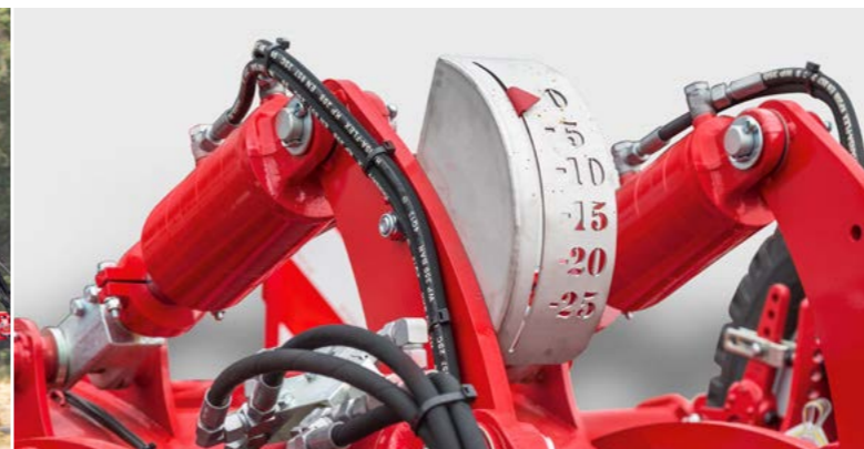
Опция Для Joker 5/6/8 RT: гидравлическая регулировка глубины хода
