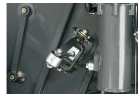
Автоматическая система очистки 3D сочетает в себе гидравлическую и механическую системы и при этом полностью отказывается от электронных датчиков.
