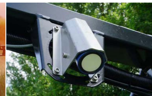
Дополнительное оснащение еще двумя ультразвуковыми датчиками
