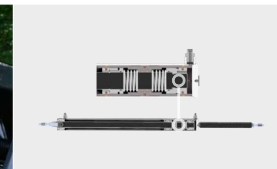
MotionControl для амортизации горизонтальных колебаний крыльев штанги
