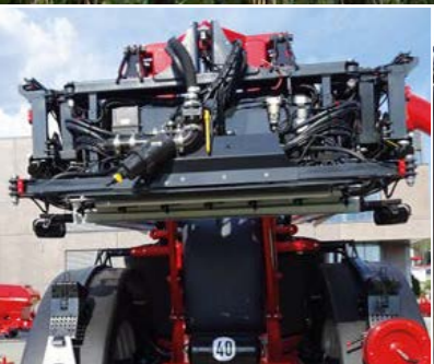
Средняя часть штанги шириной захвата 18–30 м, опционально с маятниковой рамой.
