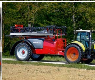
Штанга находится на достаточном удалении от кабины трактора
