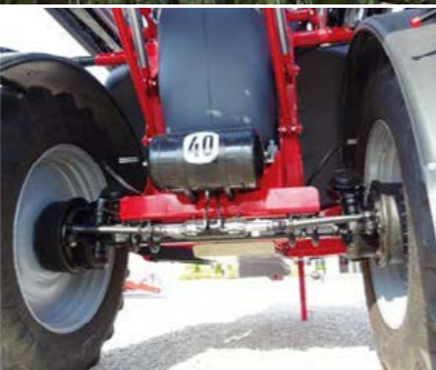
Варианты амортизации бака: без амортизаторов, подушки-эластомеры или пневмоамортизаторы.
