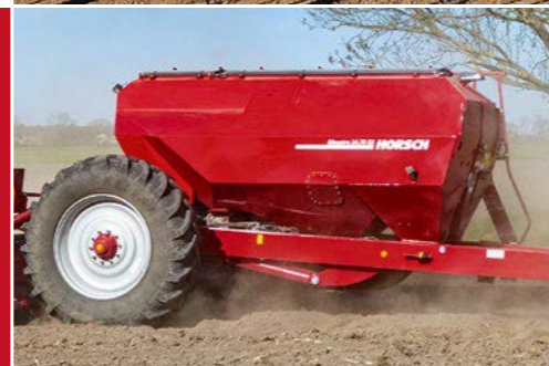
Двухсекционный бункер с отсеком 2 000 л для семян и 7 000 л для удобрений для Maestro 24 SV/SX и 36 SV
