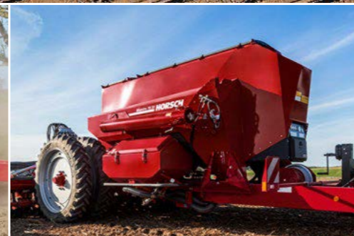
Двухсекционный бункер с отсеком 2 200 л для семян и 5 400 л для удобрений
