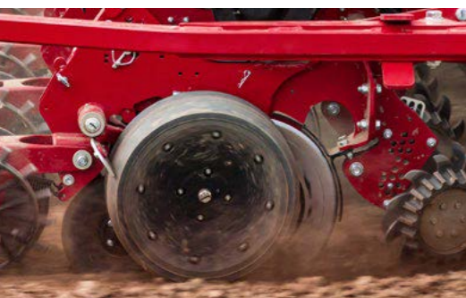
Мощный двухдисковый сошник со стабильным ведением по глубине. минимальной подверженностью износу.
