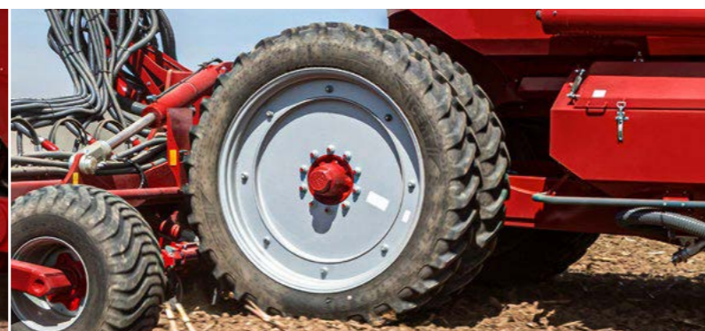
Спаренные колеса с шинами 300/95 R 46 для междурядий 45 и 50 см
