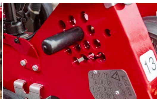
Кулиса с 14 отверстиями для регулировки глубины хода
