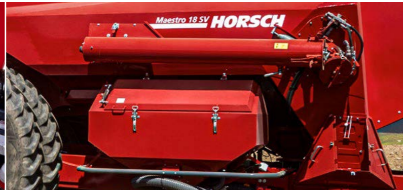
Загрузочный шнек и центральный бункер для микрогранул объемом 400 или 500 л.
