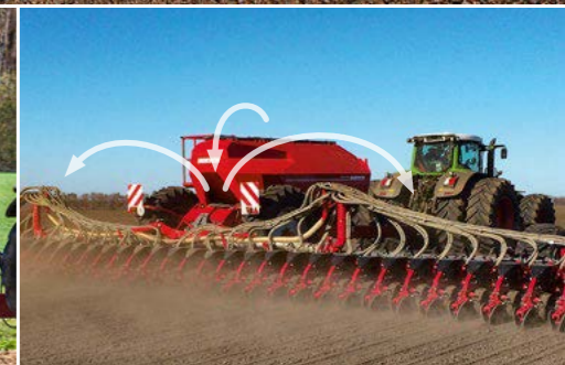
Перераспределение веса бункера для доавливания высевальной секции и снижения опорной нагрузки на колеса
