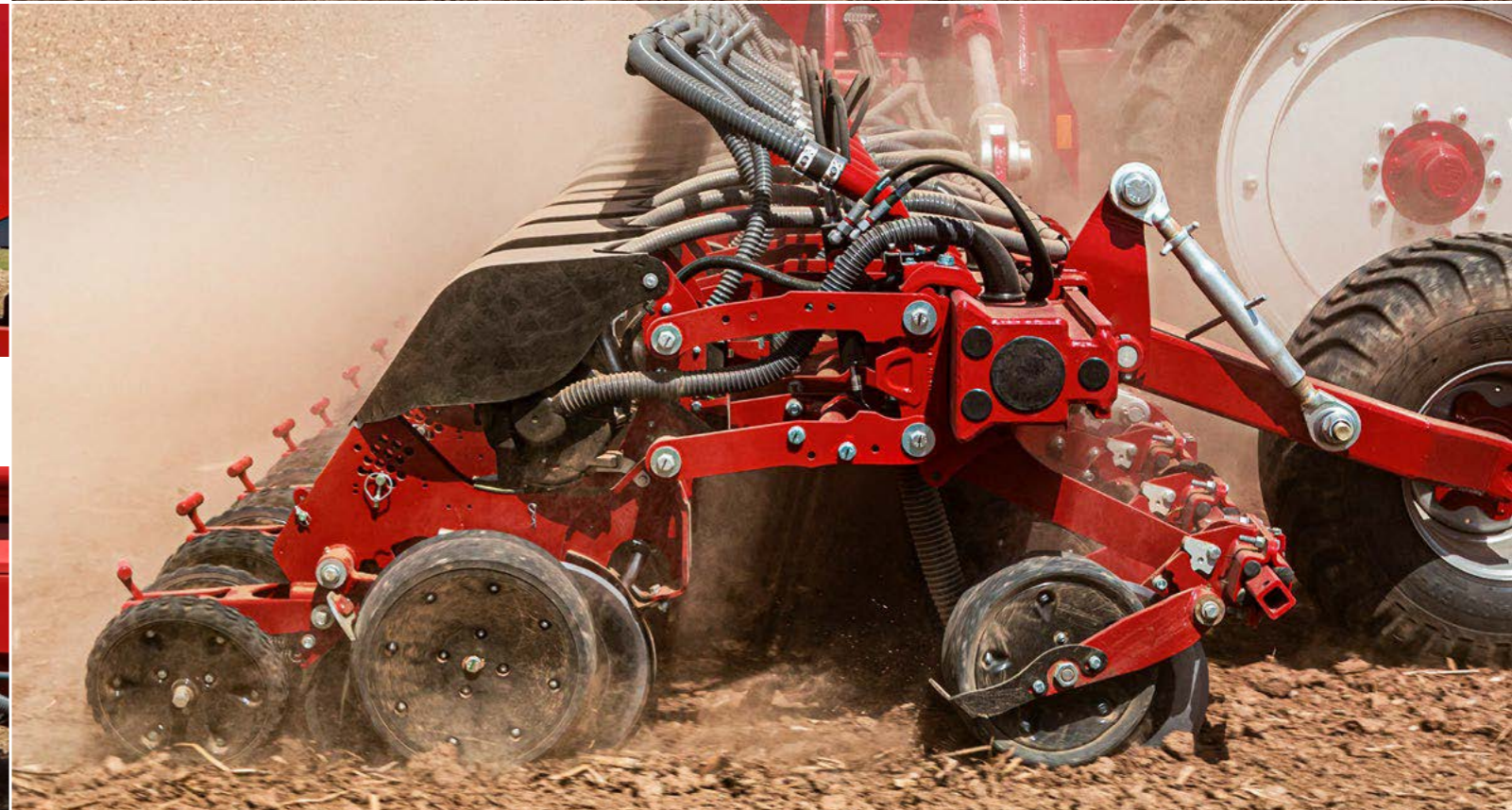
Однодисковый туковый сошник на отдельном валу и массивная высевальная секция Maestro SV/SX с точным высевальным аппаратом и системой подачи семян Main Tank Supply System (MTS)
