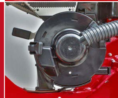
Хорошо доступный дозатор с ассортиментом дозирующих дисков для разных культур.
