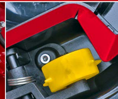
Ролик-звездочка для очистки диска
