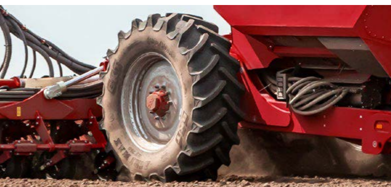
Шины 580/70 R 38 большого диаметра и большой площадью опоры
