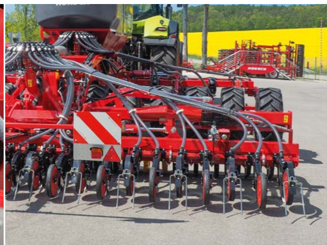
Сошник TurboDisc осуществляет посев точно в центр борозды, прорезанной стойкой TerraGrip и уплотнённой колесом почвоуплотнителя
