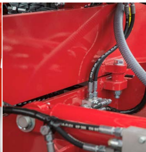
Удобное переоборудование рабочих органов. Замена рам со стойками на дисковые батареи происходит посредством 4 резьбовых соединений.
