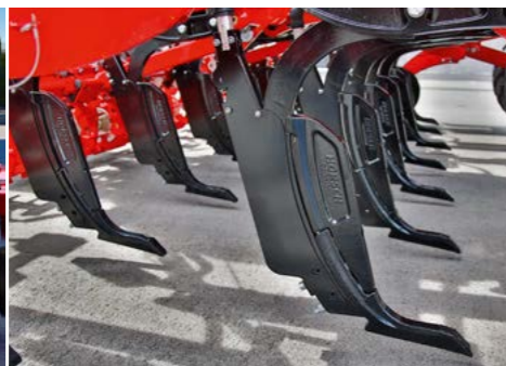
Ультра узкие наконечники ULD+ позволяют проводить глубокую обработку почвы без образования глыбистой поверхности
