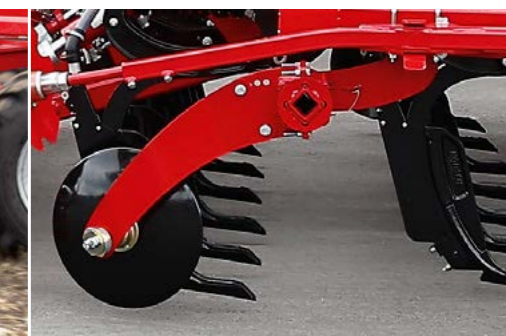
Крайний диск Позиция и угол атаки регулируются в соответствии с почвенными условиями и глубиной обработки.
