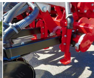
MiniDrill PPF: трубчатые сошники с отбойниками
