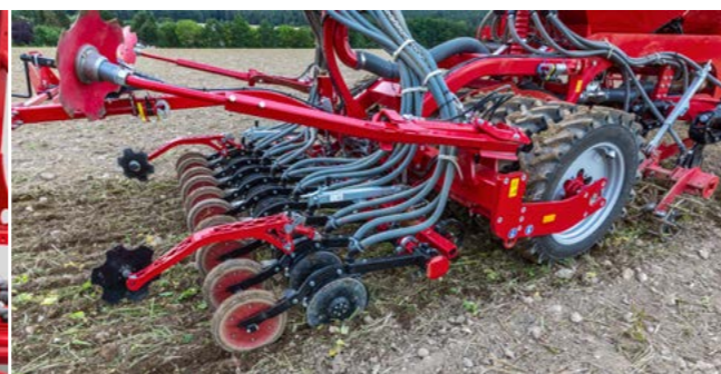
Исключительная способность сошников TurboDisc с интегрированным прикатывающим роликом копировать (до 15 см) микрорельеф поля является залогом точной выдержки заданной глубины посева. Высокая степень прижатия сошников (до 120 кг/сошник) делает возможным качественный сев на высокой скорости более 12 км/ч.
