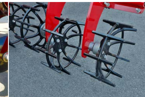
Крошитель для создания мелкокомковатой структуры почвы в горизонте посева.
