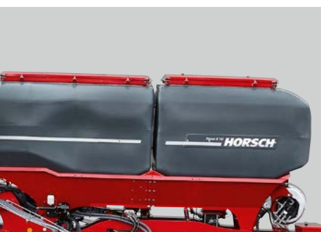
5 000 л бункер (Focus 4 и 6 TD) (Бункеры: 2 000 л спереди – 3 000 л сзади)
