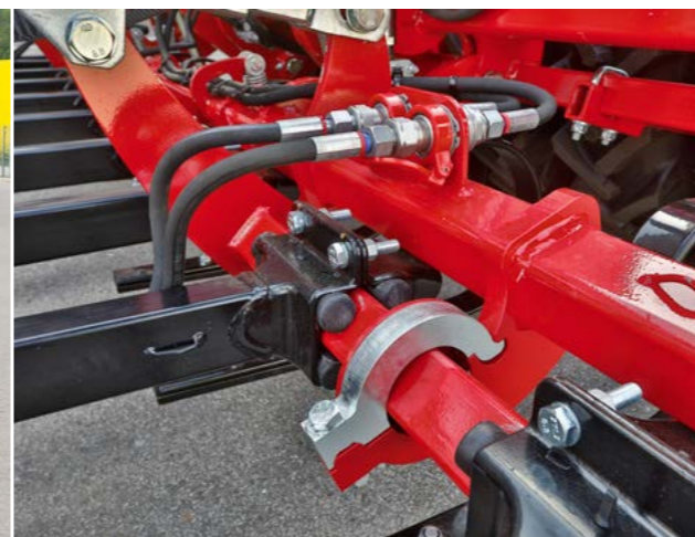
Система быстрой смены высевальных секций
