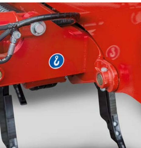
Удобное переоборудование рабочих органов. Замена рам со стойками на дисковые батареи происходит посредством 4 резьбовых соединений.
