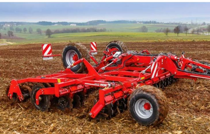
Шасси в центре рамной конструкции
