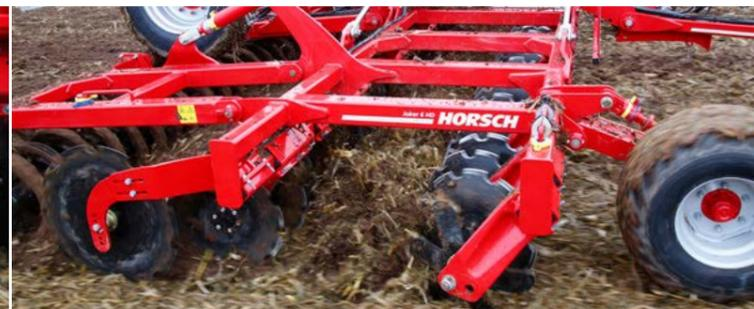
Joker создает мелкокомковатую структуру почвы и равномерно уплотненное строение обработанного слоя, что благоприятствует быстрому появлению всходов
