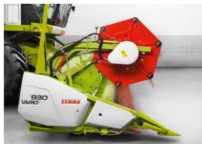
Стол жатки задвинут – уборка зерновых (–100 мм).
