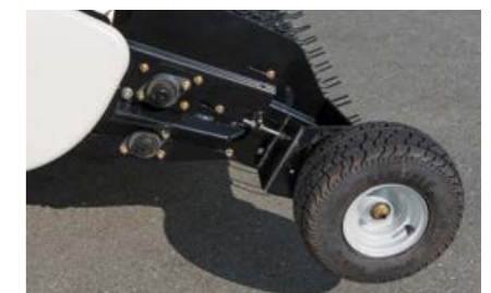
Копирующие колеса ограничивают глубину.
