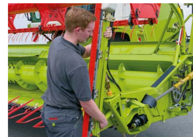
Установка рапсовых ножей с помощью быстродействующего затвора.
