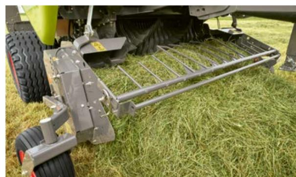
Управляемый подборщик адаптируется к любому рельефу почвы грунта даже на высоких скоростях работы и при прохождении поворотов. Большие копирующие колеса надежно удерживают его на траектории. Колеса регулируются без использования инструментов.
