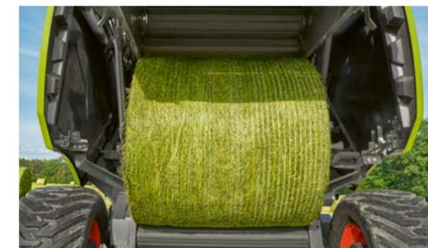
Задняя дверь ROLLANT 540 автоматически открывается и закрывается всего за шесть секунд, как только тракторист включит нейтральную передачу. Работу механизатора облегчают также автоматический цикл очистки ножей, автоматическое отключение ножей и удобное переключение групп ножей из кабины.
