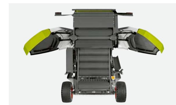
С помощью 17 вальцов HD в корпусе увеличенной толщины растительная масса прессуется в туки одинаковой формы размером 1,22 x 1,50 м — с обвязкой сеткой или шпагатом на выбор.
