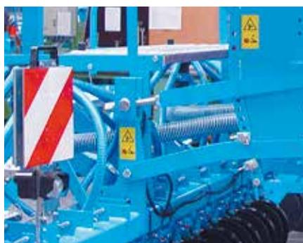
**Регулировка глубины посева**
